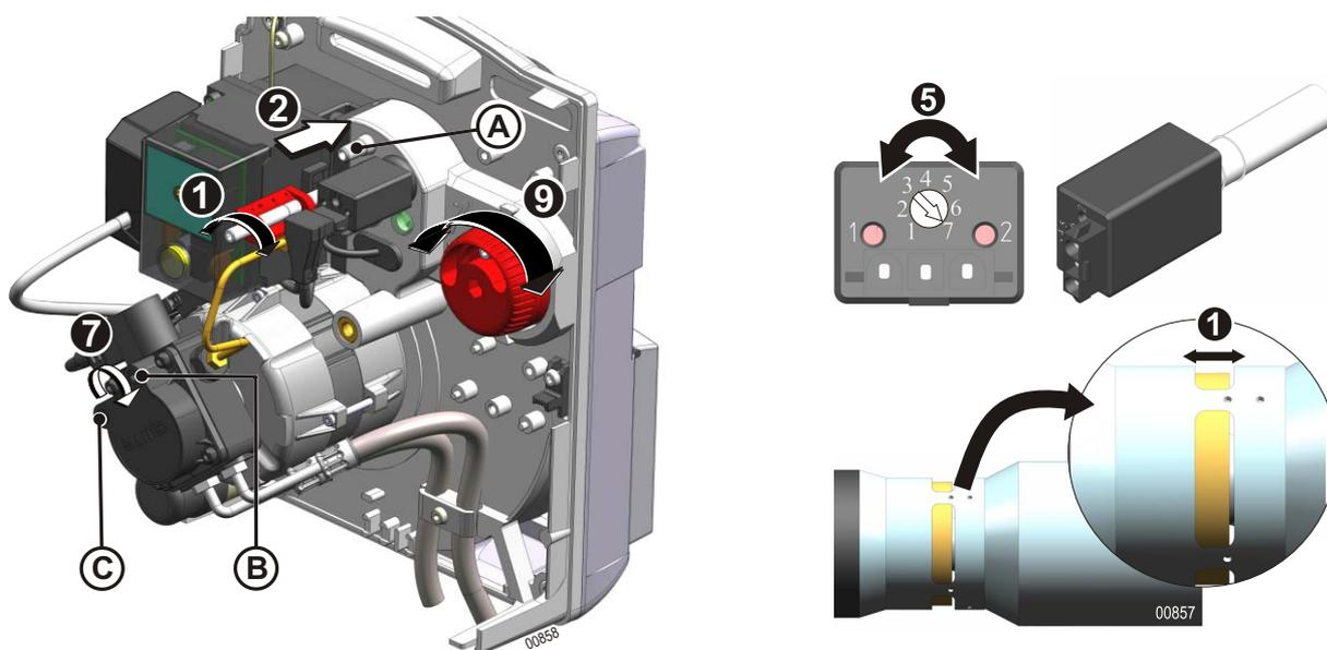
❶ Régler la fente de recirculation à l'aide de la vis de réglage.
