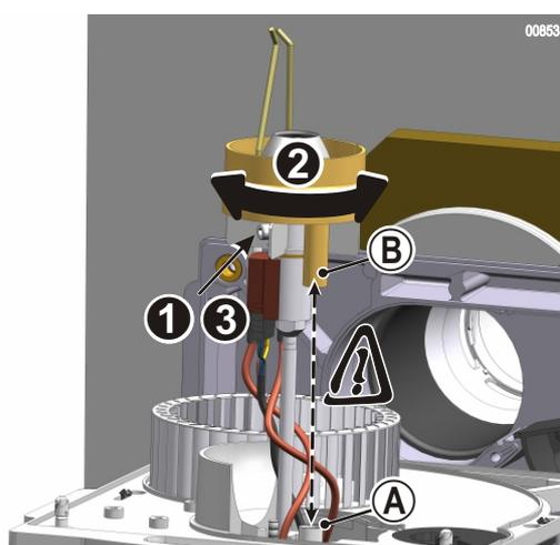
**⚠** Aligner la cellule de détection de flamme avec le miroir de la tête de combustion .
